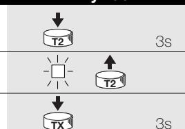
Uwaga: Jeśli wczytywanie zakończyło się powodzeniem "dioda radio" mignie 3 razy. Jeśli są następne nadajniki do wczytywania do pamięci odbiornika, powtórzyć krok 3 w ciągu 10 sekund, w przeciwnym przypadku faza wczytywania zakończy się.
