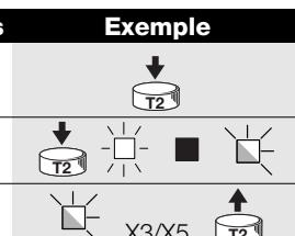
Note: Durant l'effacement, la «led radio» clignote rapidement et la fin de l'opération est signalée par 5 clignotements. L'effacement complet de la mémoire modifie également les éventuelles programmations effectuées (temps de travail, adresse TTBUS, ...) et reconfigure la logique de commande selon les paramètres d'usine.
