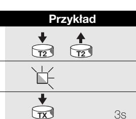
Uwaga: Jeśli wczytywanie zakończyło się powodzeniem "dioda radio" wykona 3 powolne mignienia. Jeśli są jeszcze inne nadajniki do wczytywania, powtórzyć krok 3 w ciągu do 10 sekund, w przeciwnym przypadku faza wczytywania zakończy się.
