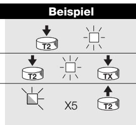
Anmerkung: wenn man weitere Sender löschen will, müssen für jeden Sender alle Schritte wiederholt werden. Ist ein Sender im Modus II gespeichert, muss jede gespeicherte Taste gelöscht werden.
