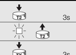
Anmerkung: Die LED "Radio" wird 3 Mal blinken, falls die Speicherung erfolgreich war. Schritt 3 innerhalb der nächsten 10 Sekunden wiederholen, wenn man weitere Sender speichern will, andernfalls wird die Speicherung beendet.
