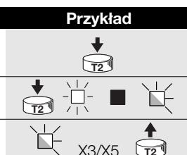
Nota: Uwaga: Podczas kasowania "dioda radio" będzie szybko migać, a zakończenie operacji sygnalizowane będzie 5 mignięciami. Całkowite kasowanie pamięci zmienia także ewentualne programowanie (czas pracy, adres TTBUS,...) przywracając centralce konfigurację fabryczną.
