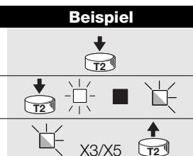
Anmerkung: Während des Löschens führt die LED „Radio“ ein Schnellblinken aus; das Ende des Vorgangs wird durch ein 5-maliges Blinken gemeldet. Durch das vollständige Löschen des Speichers ändern sich auch eventuell ausgeführte Programmierungen (Arbeitszeit, TTbus-Adresse, usw.) und die Steuerung wird in die werkseitige Konfiguration rückgesetzt.
